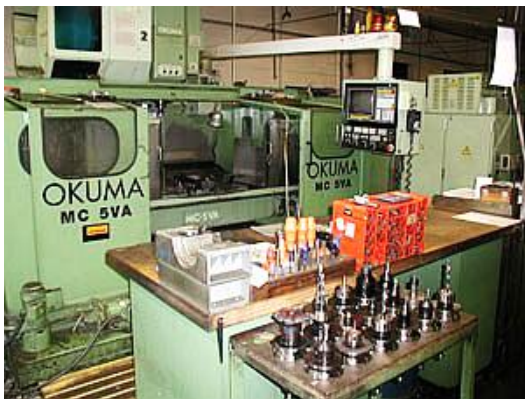
Vertikal-Bearbeitungszentrum OKUMA MC-5VA
