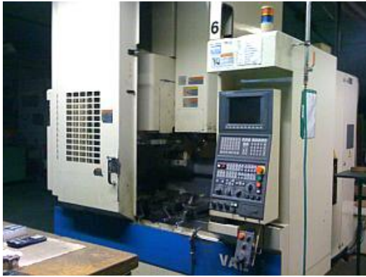
Vertikal-Bearbeitungszentrum OKUMA MX-45VAE
