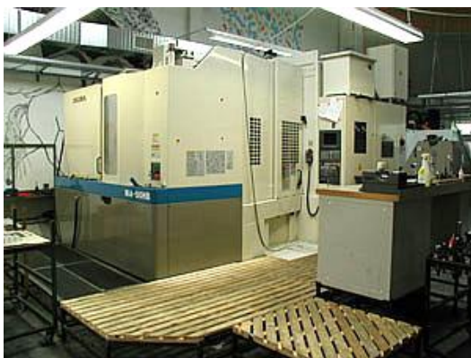
Horizontal-Bearbeitungszentrum OKUMA MA-50HB
