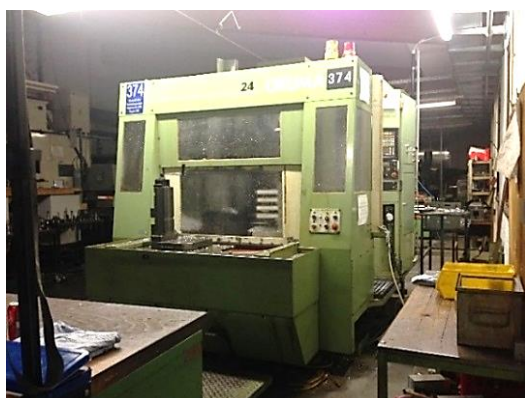
Horizontal-Bearbeitungszentrum OKUMA MC-40H
